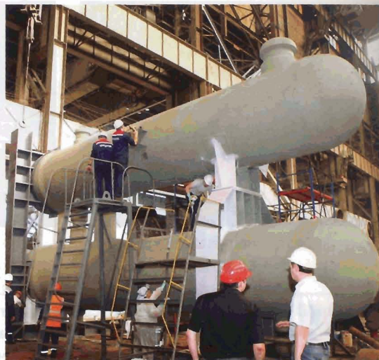
Производство блока теплообменника высокого давления
